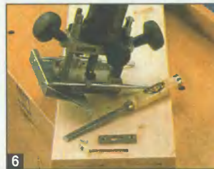
6 Гнезда для врезки мебельных стяжек можно выбрать как фрезой, так и обычной стамеской.
