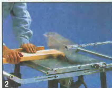
2 Очень важно торцевыерезы при раскрое заготовок сделать точно под прямым углом.
