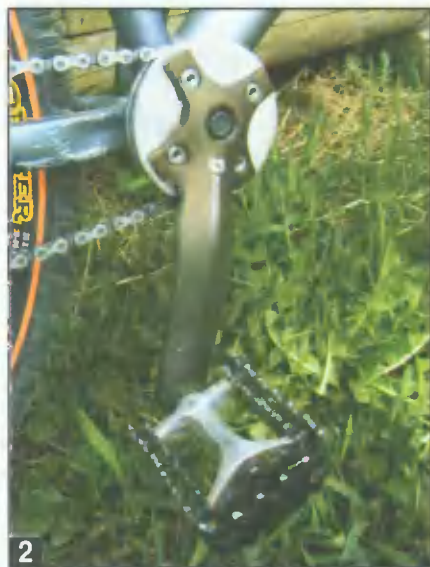
Шатунная система Sugino, двойной рокринг (внутренний рокринг препятствует соскакиванию цепи) и педали VP с двойной рамкой для лучшей фиксации ноги.
