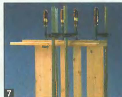
7 Тщательно отшлифовав наждачной бумагой, детали 1, 3, 4 и 5 склеивают на плоских шпонках строго под прямым углом друг к другу.
