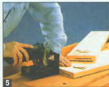
5 В торцевых кромках горизонтальных перекладин 3 и 4 пазы под шпонки должны располагаться точно посередине. В этом случае дополнительная прокладка не нужна.
