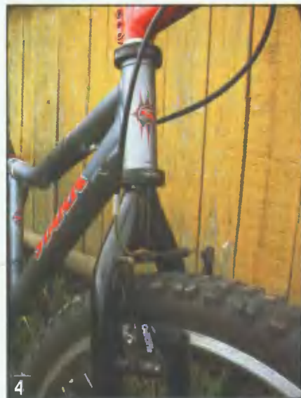
Передний тормоз Shimano Deore, вилка Atom Trial Alu (обратите внимание на площадь контакта ног вилки и рулевой трубы в месте сварки)
