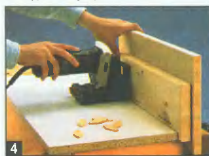
4 При выборке пазов для плоских шпонок в стойках 1 и 2 под подошву инструмента подкладывают дистанционную плиту-прокладку толщиной 19 мм.
