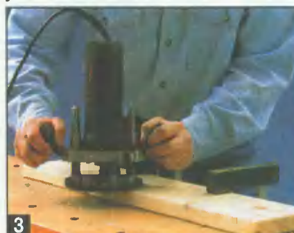
3 После обработки деталей в размер следует закруглить у них все кромки радиусом не менее 3–5 мм. Удобнее всего это сделать фрезой с упорным кольцом.
