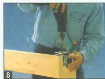
8 В верхних торцевых кромках стоек 1 и в нижних кромках стоек 2 сверлят по кондуктору по два отверстия для шкантов Ø8 мм.
